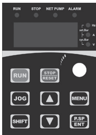
Рис. 8 Дисплей частотного преобразователя CUE10
